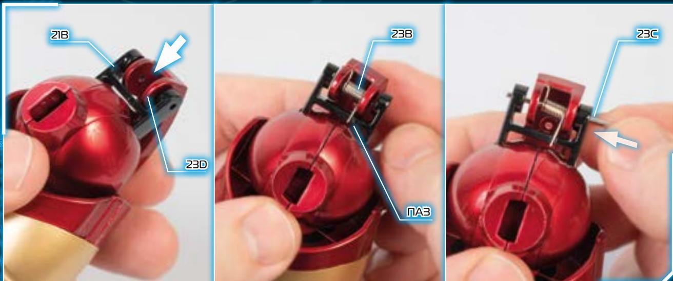
2 - Установите деталь 23D на рамке (21В) так, чтобы их отверстия совпали. Затем, руководствуясь центральной фотографией, поместите между ними пружину (23В): один ее конец, изогнутый под прямым углом, должен попасть в соответствующий паз детали 23D, а второй конец — в паз рамки (21В). Зафиксируйте собранную конструкцию с помощью штифта (23С).
